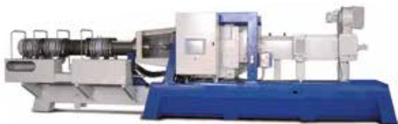
Processo de extrusão que permite o cozimento ideal do amido garantindo alta digestibilidade.
